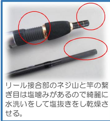
リール接合部のネジ山と竿の繋ぎ目は塩噛みがあるので綺麗に水洗いをして塩抜きをし乾燥させる。
