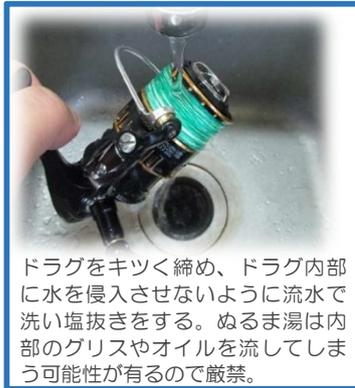
ドラッグをキツく締め、ドラッグ内部に水を侵入させないように流水で洗い塩抜きをする。ぬるま湯は内部のグリスやオイルを流してしまう可能性があるので厳禁。
